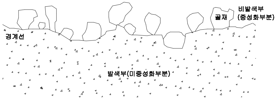
【그림 2.3】 페놀프탈레인법에 의한 탄산화부분과 미탄산화부분의 경계
